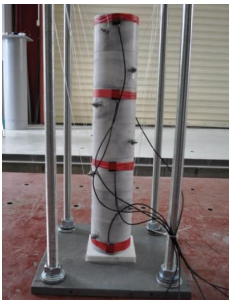
Εικ. 2.3: Επιταχυνσιόμετρα τοποθετημένα στον κίονα
