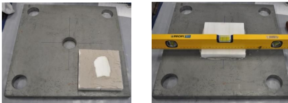
Εικ. 1.1: Προετοιμασία μεταλλικής πλάκας (αριστερά) και μαρμάρινη πλάκα πακτωμένη (δεξιά)
