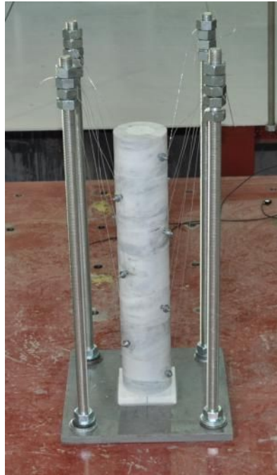
Εικ. 2.1: Κίονας τοποθετημένος στην σεισμική τράπεζα
