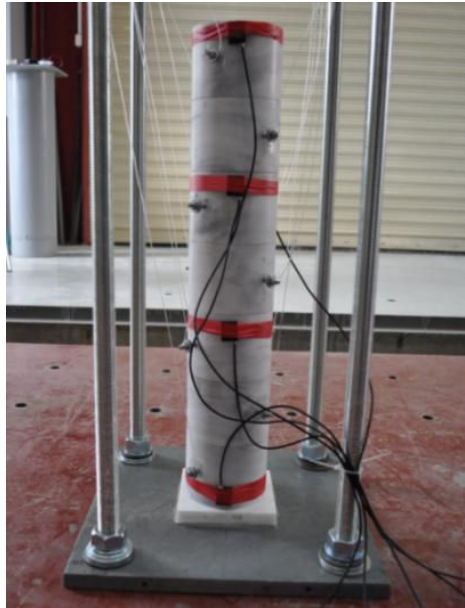
Εικ. 2.3: Επιταχυνσιόμετρα τοποθετημένα στον κίονα
