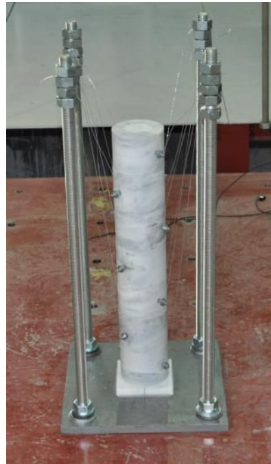
Εικ. 2.1: Κίονας τοποθετημένος στην σεισμική τράπεζα
